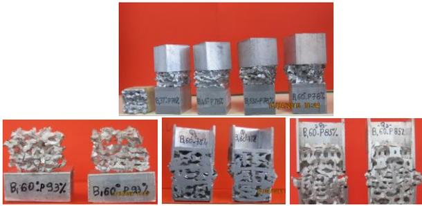
**Fig.2** Aperçu de l'évolution la structure interne des spécimens des trois types de mousse MP93, MP85 et MP78 en fin de flambage plastique pour la configuration biaxiale Bi60°.
