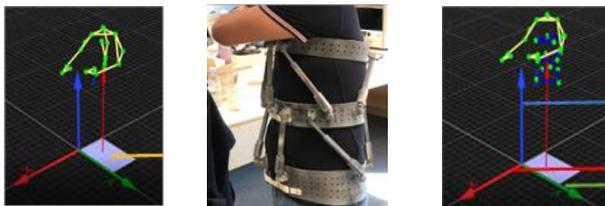
Figure 5 - Suivi de la mobilité du corset pour un mouvement de rotation autour de l'axe vertical
