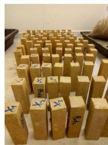
Figure 2 – Les éprouvettes dans la chambre climatique à une température de  $20\text{ }^{\circ}\text{C} \pm 1$  et une humidité relative de 50 %
