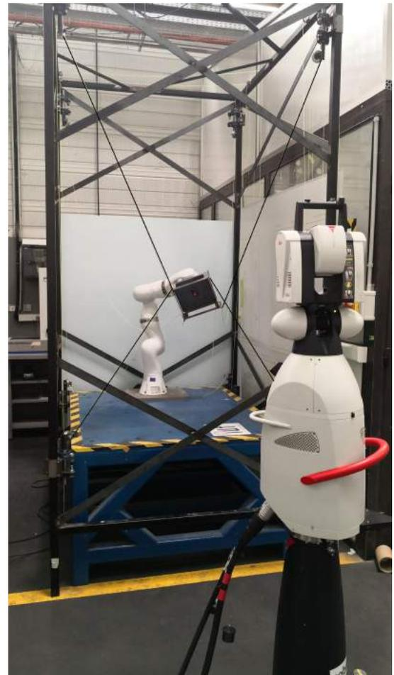
FIGURE 3 – Dispositif de sollicitations de robot industriel
