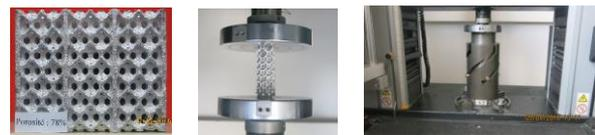
**Fig.1** Aperçu de des spécimens bruts et exemples de tests uniaxial et biaxial.
